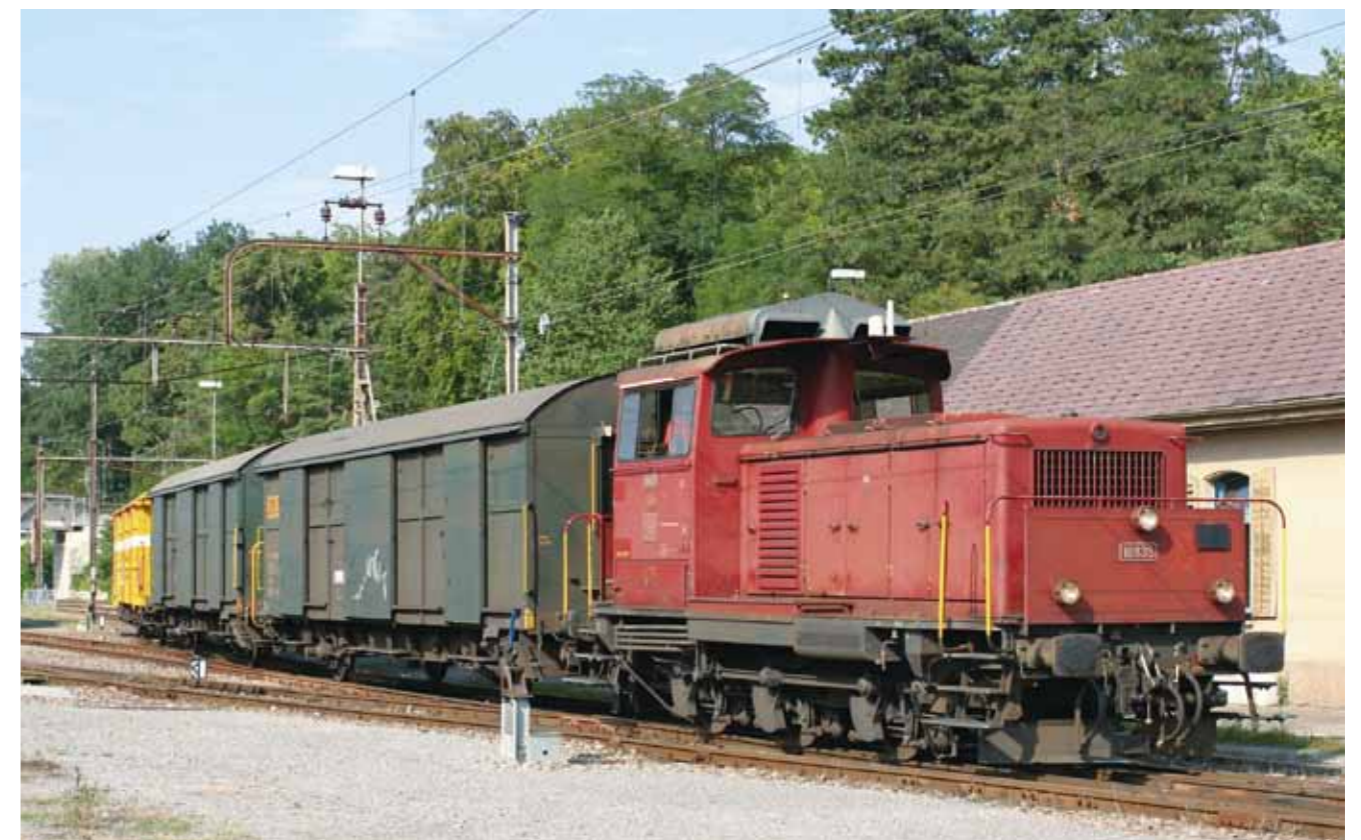
Bei Rangierarbeiten mit zweiachsigen Postwagen konnte die Em 3/3 18835 am 17. Juli 2007 im ehemaligen Winterthurer Rangierbahnhof beobachtet werden. Bei dieser Lok wurden die ursprünglichen Puffer mit runden Tellern gegen neue Hochleistungspuffer getauscht.
