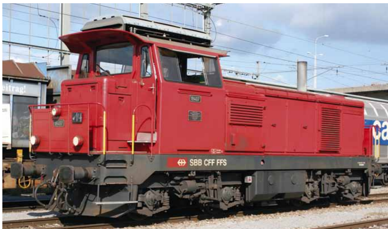
Am 31. August 2007 war die Bm 4/4 18407 als 14. Rangierlok in Zürich Vorbahnhof im Einsatz. Im Vergleich mit den beiden oberen Bildern fällt das neu eingebaute seitliche Führerstandsfenster auf. Dagegen ist immer noch ein Bühnengeländer der ursprünglichen Ausführung montiert.
