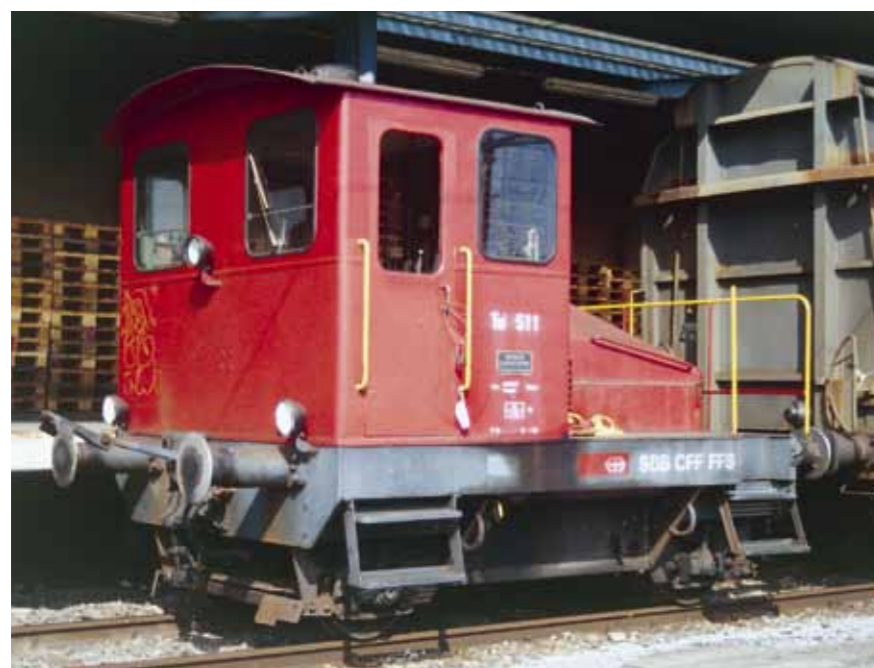
Unmittelbar nach der durch die Serviceanlage im Rangierbahnhof Limmattal durchgeführten technischen Kontrolle – die entsprechende Anschrift «TK SA RBL 02.07» ist unter den Gewichtsangaben zu erkennen – entstand dieses Bild des Tm I 511 am 22. Februar 2007 ebenda.
