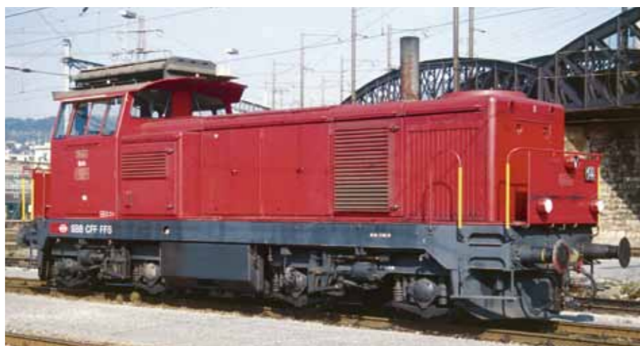
Diese Rückansicht der Bm 4/4 18423 entstand am 27. August 2007 im Rangierbahnhof Limmatal. Ausser dem Abgaskamin, den Hochleistungspuffern, dem Bühnengeländer und dem erst nachträglich montierten Magnet der Zugsicherung befindet sich die Lok äusserlich praktisch immer noch im Ablieferungszustand.
