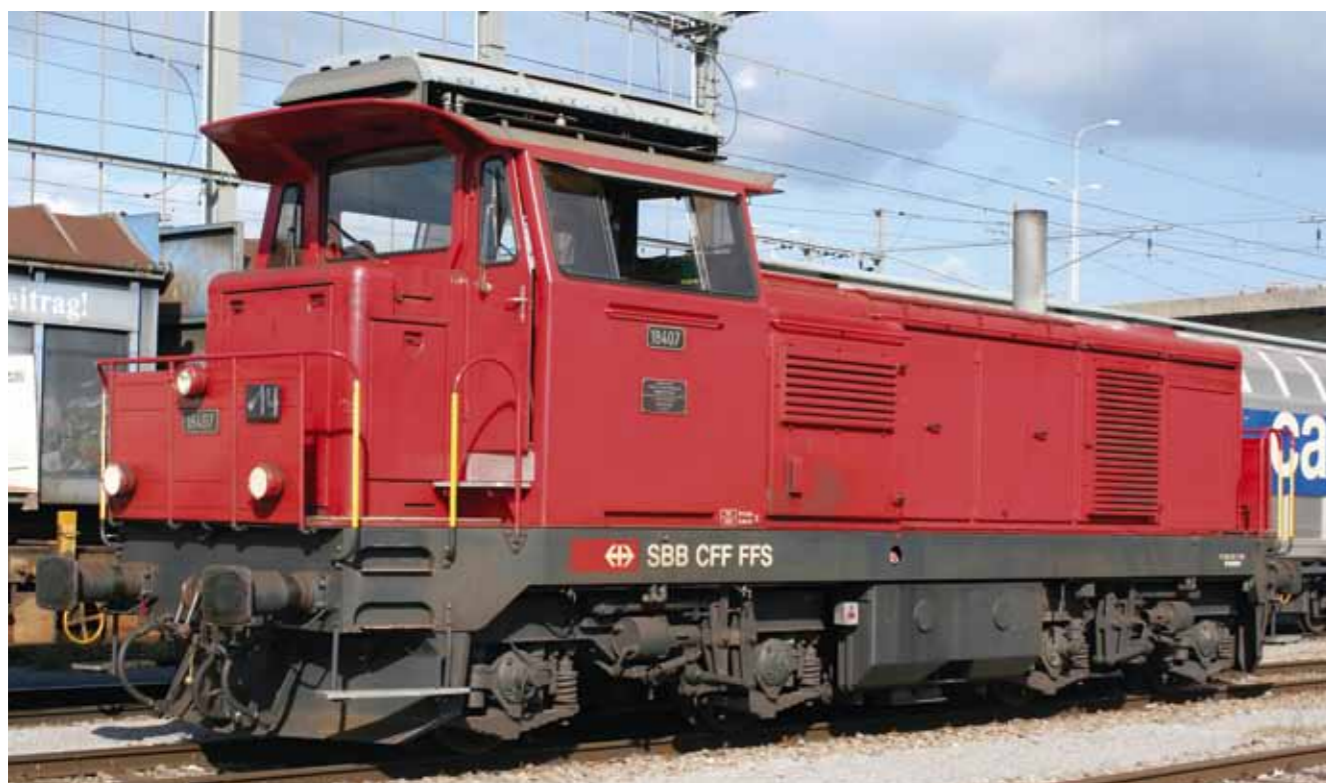
Am 31. August 2007 war die Bm 4/4 18407 als 14. Rangierlok in Zürich Vorbahnhof im Einsatz. Im Vergleich mit den beiden oberen Bildern fällt das neu eingebaute seitliche Führerstandsfenster auf. Dagegen ist immer noch ein Bühnengeländer der ursprünglichen Ausführung montiert.
