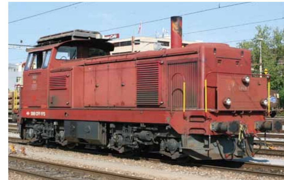
Die Bm 4/4 18414 ist wie auch die ebenfalls SBB Cargo gehörende 18408 mit der RBS-Zugsicherung ZSL90 für den Einsatz auf dem Dreischienengleis Zollikofen–Worblaufen–Deisswil ausgerüstet. Neben dem SBB-Logo am Rahmen fällt der vom Personal mit dem Berner Wappen verzierte Abgaskamin auf. Bern Weyermannshaus, 26. Juli 2006.
